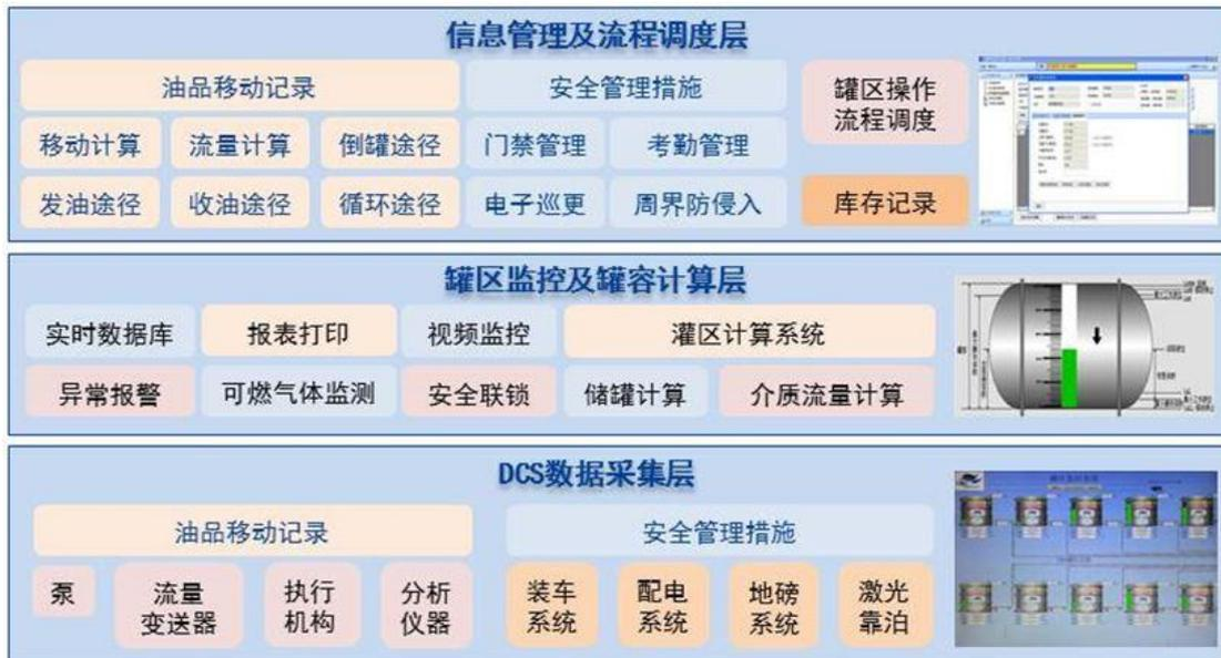
图 1 罐区整体解决方案架构
